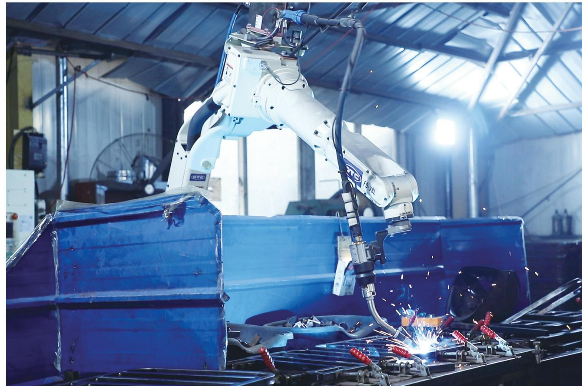
焊接机器人 Welder Robot 数量: 6台 Quantity: Six
